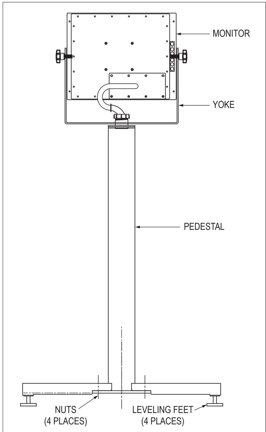
FIGURE 1 – ROLLING MOBILE PEDESTAL WORKSTATION
